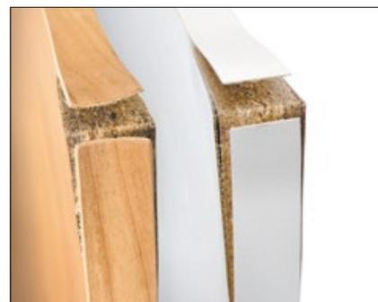
Ante in truciolare (impiallacciata e laminata), bordate con colla termofondente con temperatura di rinvenimento di 70°C, esposte al vapore per 30 minuti.
