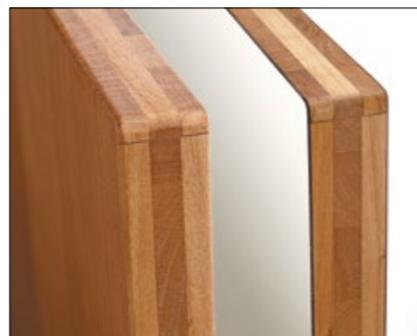
Ante in truciolare resistente all'umidità tipo P3 (impiallacciata e laminata), premassellate, esposte al calore (120°C) per 30 minuti.
