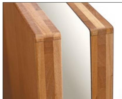
Ante in truciolare resistente all'umidità tipo P3 (impiallacciata e laminata), premassellate, esposte al vapore per 30 minuti.
